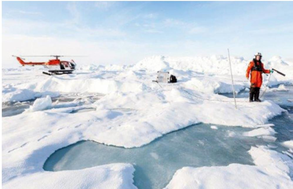
Ein AWI-Wissenschaftler nimmt abseits des Schiffes ein XCTD Profil auf, um die schiffsbasierten Messungen zu komplementieren. Bei einer XCTD wird ein Messgerät mit Temperatur-, Salinität- und Drucksensoren ins Wasser gesetzt und die Daten über ein sehr dünnes Kupferkabel an die Oberfläche übertragen.
